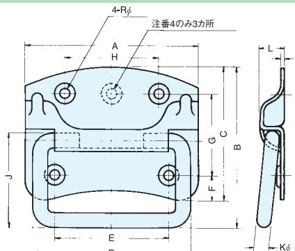
材質：冷間圧延鋼板 (SPCC)
