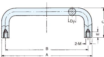
材 質：ステンレス鋼棒 (SUS-304)
