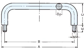
材 質：ステンレス鋼棒 (SUS-304)
