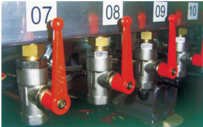
排気口にねじ継手接続
